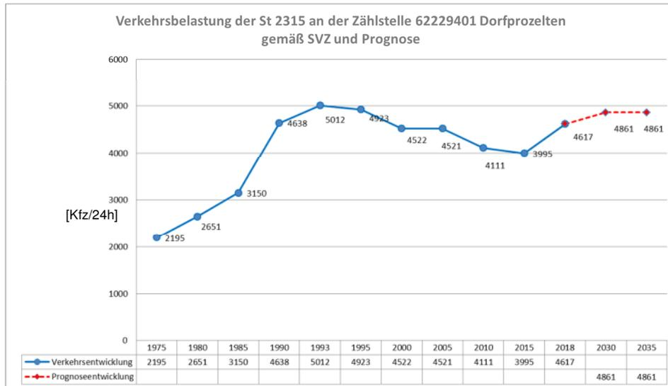
**Abbildung 4: Ergebnisse der SVZ DTV alle Tage an der St 2315 sowie Prognose 2030/2035**
