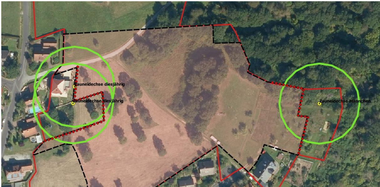
Abb. 7: Fundpunkte Zauneidechse (gelb), die im Laufe der Kontrollbegehungen festgestellt wurden und 40m Radius (hellgrün). Vergrämuungs- oder Abfangmaßnahmen können sich auf die hellgrünen Radien beschränken. Die Bautabuzone ist zu kennzeichnen (Absperrband) bzw. besser zu sichern (Bauzaun) (rot gepunktete Linien) Plangebiet (rot skizziert), Grenze des Allgemeinen Wohngebietes incl. Verkehrsflächen aus dem neuen Bebauungsplan (schwarz gestrichelte Linie, skizziert) (Quelle Luftbild: Geobasisdaten: Bayerische Vermessungsverwaltung).
